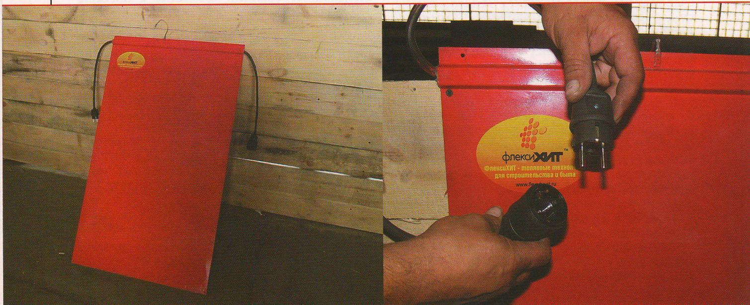
перекрытиях зданий, устройстве бетонных полов, дорожных и аэродромных покрытий. Выделяя инфракрасную энергию в длинноволновом диапазоне, термомат создает равномерный тепловой поток, что, в свою очередь, хорошо сказывается на условиях твердения бетона. Бетон активно поглощает тепло, наравне с контактным теплообменом происходит глубокое инфракрасное проникновение тепла в массу бетона.
